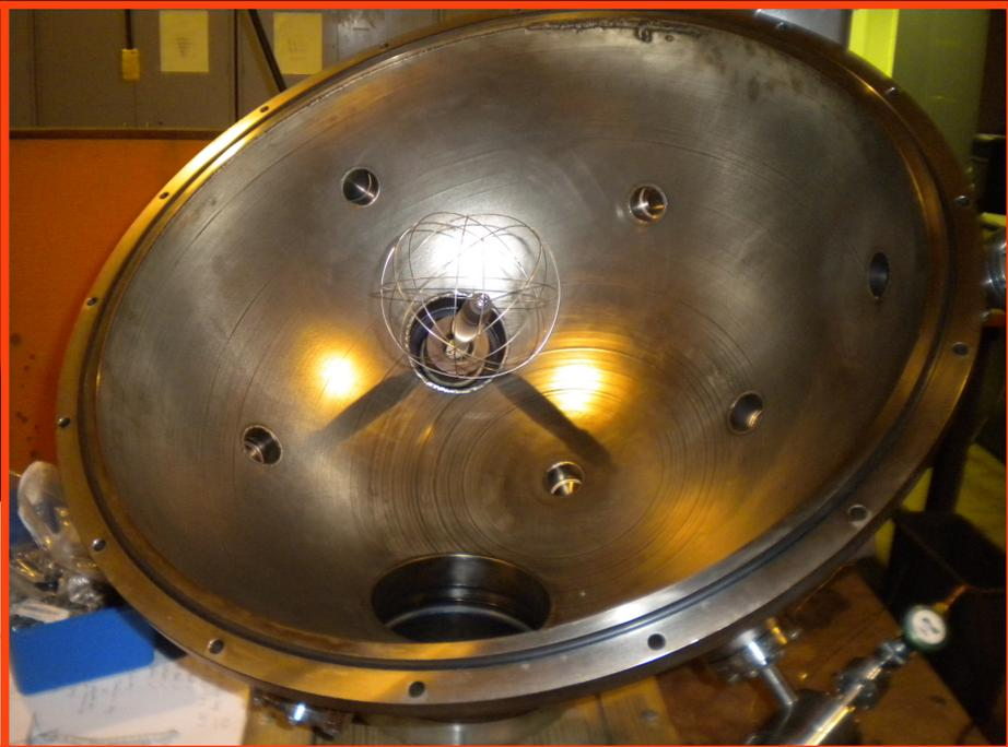
Generador de IECF, desarmado, diámetro  $\sim 60$  cm
