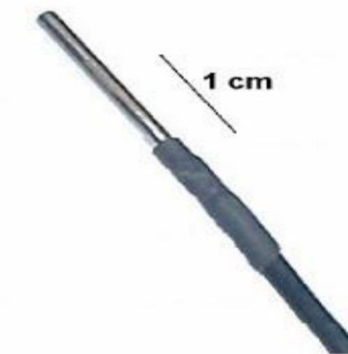
Fotografía de la parte sensible de un SPND
